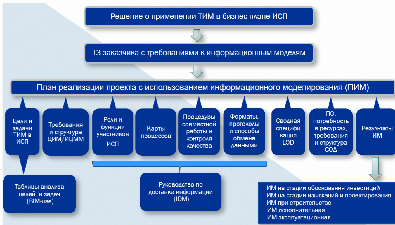
Рисунок Ж.1 – Рекомендуемые документы для реализации инвестиционно-строительного проекта с использованием технологий информационного моделирования
